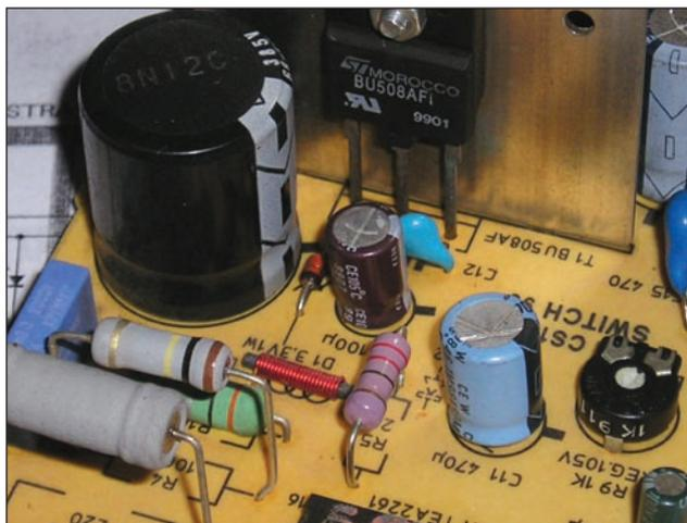
Foto 6 - Il transistor BU508 posto come commutatore sul nostro SMPS
