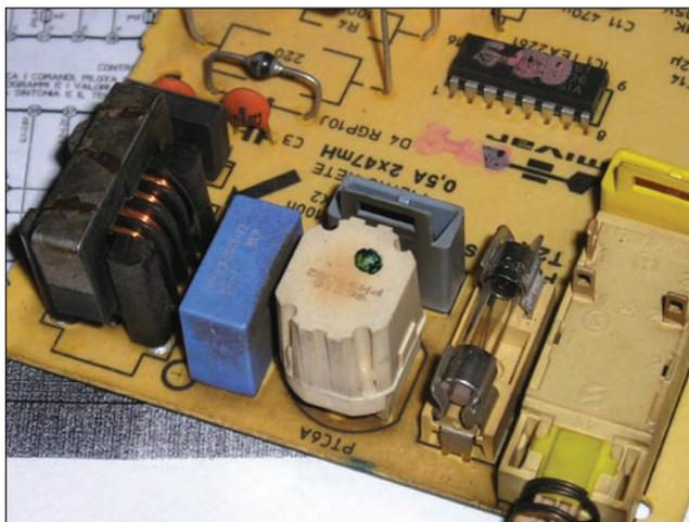
Foto 5 - Ecco dove si trova la sezione di smagnetizzazione e il fusibile appena sostituito
