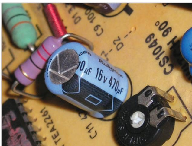
Foto 7 - Ecco dove si trova il condensatore di alimentazione dell'integrato TEA2261
