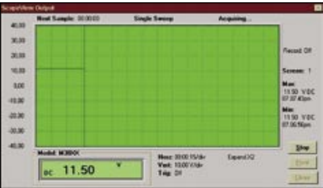
Fig. 2 - Il grafico mostra una linea retta: la tensione di polarizzazione è perfettamente stabile
