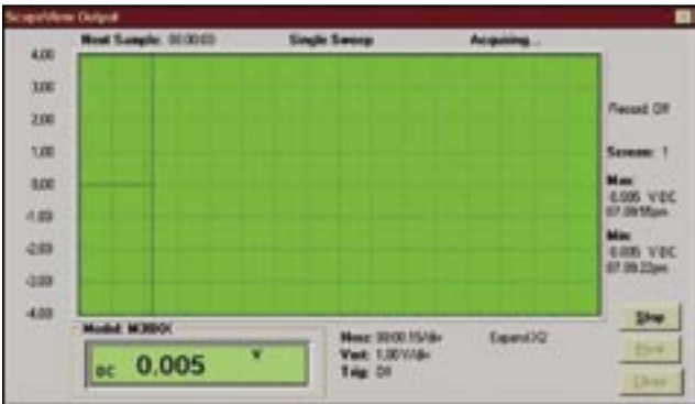
Fig. 3 - Tensione al pin 3 del controllore TEA2164. In basso a sinistra è visibile la tensione misurata a display, mentre il grafico mostra l'andamento rettilineo della tensione (quasi nulla)
