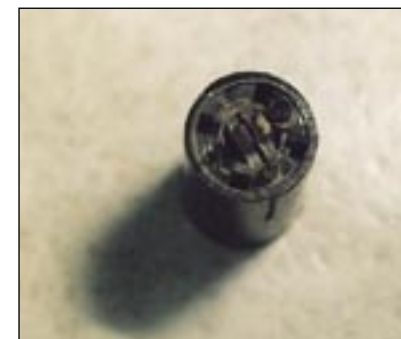
Foto 7 - La bobina di correzione oggetto del nostro ultimo intervento sembra intatta
