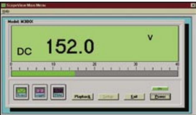
Fig. 4 - Ai capi di C766 è rilevata la d.d.p. visibile in figura. Ne consigliamo sempre il rilevamento attraverso un tester digitale
