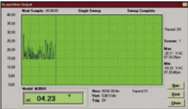
Fig. 10 - Il comportamento della tensione alternata ai capi della resistenza R530 mostra qualcosa di anomalo: i picchi sono sicuramente dannosi e provocano senza dubbi dei problemi
