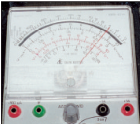
Foto 9 - Voltaggio necessario al circuito verticale per un corretto funzionamento. Si legga la terza scala inferiore: sono stati visualizzati circa 26,7V con tester posto a 30V f.s.
