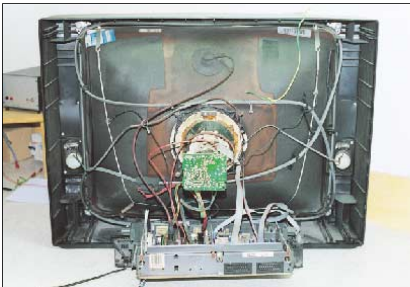
Foto 1 - Interno del telaio TX92 da 28 pollici, si noti che il TRC è di costruzione della VideoColor
