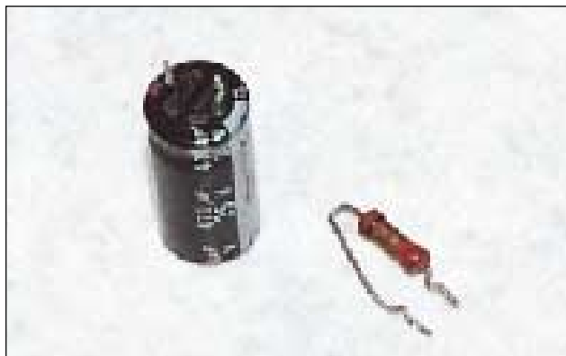
Foto 7 - i componenti rilevati in avaria sono visibili in foto, come vedremo la loro sostituzione ci ha portato ad una parziale soluzione del problema
