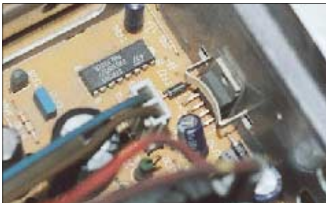
Foto 6 - circuito Controller STV2145 e TDA8177 visibile sul telaio (montato su aletta) TX92 della Telefunken
