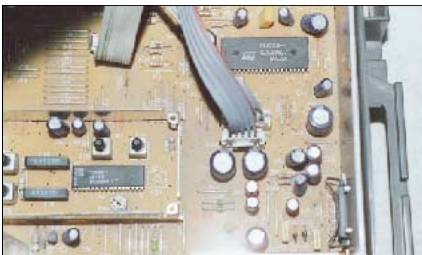
Foto 5 - sezione croma, l'integrato STV2118, unitamente all'STV2180, completano la sezione di decodifica degli standard video di questo telaio
