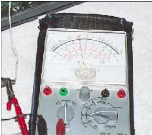
Foto 4a e 4b - Le due foto mostrano il punto di contatto esterno e i 13V inseriti necessari ad escludere lo stadio orizzontale
