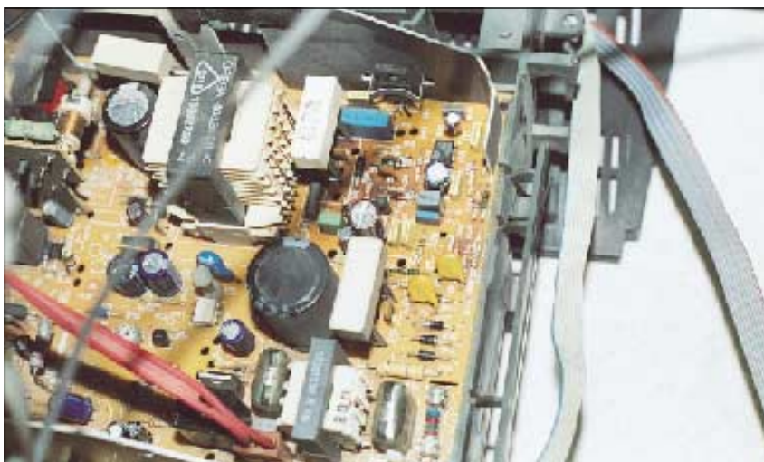
Foto 2 - Sezione power supply, il transistor MOS, un STP6NA60FI, è visibile in alto mentre la sezione di Graetz è posizionata in basso a destra
