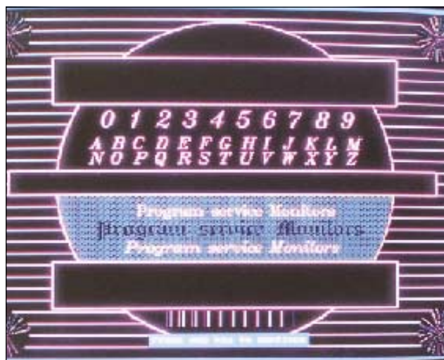
Foto 2 - Cannoni Rosso pilotato non correttamente
