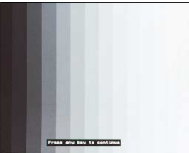
Foto 11a - Comando dei cannoni RGB dopo la soluzione del problema. Si noti il perfetto funzionamento di tutti gli stadi
