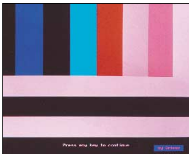
Foto 9 - È interessante notare come la sezione relativa al verde sia completamente oscurata (sesta barra verticale contando da destra). La seconda barra verticale da destra dovrebbe essere gialla
