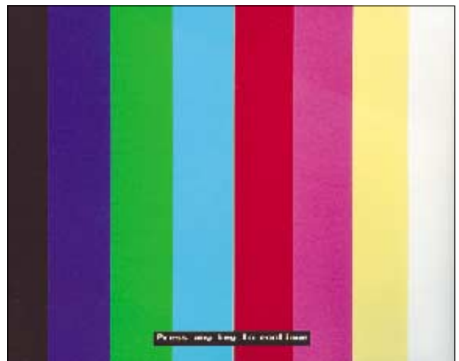
Foto 11b - Visione corretta della barra verde e del settore in giallo
