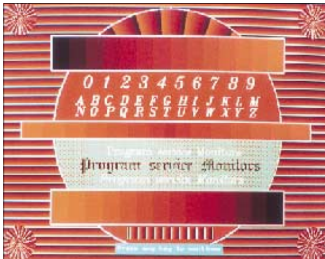
Foto 12 e 14 - Nelle Foto, rispettivamente 12 e 14 si può notare come le cromaticità dei vari livelli del rosso e del verde siano lineari. Questo è ottenuto perché la percentuale dei colori (blu compreso) è bilanciata. È possibile vedere i segnali corretti con l'oscilloscopio all'uscita delle coppie d'amplificazione
