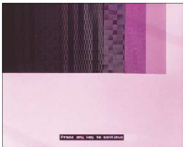
Foto 8 - Ecco come si presenta ancora il monitor dopo la sostituzione di Q201, si noti la cromaticità della parte bianca dello schermo
