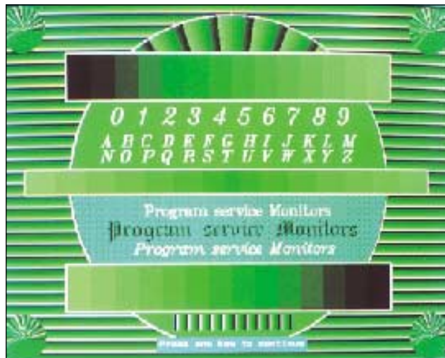
Foto 12 e 14 - Nelle Foto, rispettivamente 12 e 14 si può notare come le cromaticità dei vari livelli del rosso e del verde siano lineari. Questo è ottenuto perché la percentuale dei colori (blu compreso) è bilanciata. È possibile vedere i segnali corretti con l'oscilloscopio all'uscita delle coppie d'amplificazione
