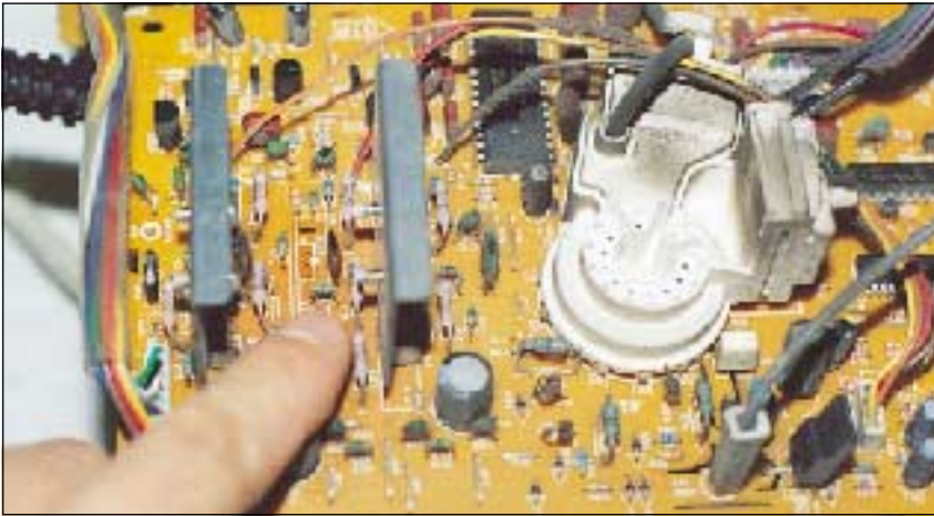
Foto 10a - Posizione dell'aletta di raffreddamento relativa a Q203 e Q204
