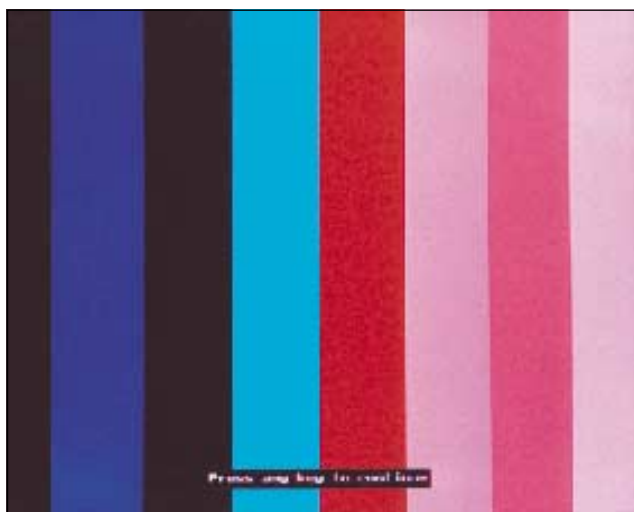
Foto 1 - Colore mancante sul cannone verde. Si noti la cromaticità falsata sul Pattern Test per il controllo generale dei colori dell'immagine mentre i colori rosso e blu sono perfetti
