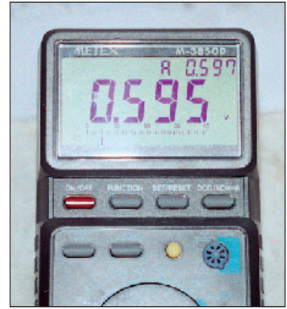
Foto 7 - Polarizzazione corretta della giunzione B-E del transistor driver 7400
