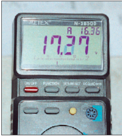
Foto 5 - Sezione verticale: sul resistore 3404 è stata rilevata una tensione un po' più alta rispetto a quella prevista nello schema
