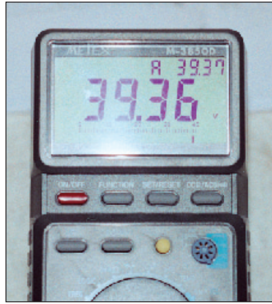
Foto 6 - Alimentazione corretta della sezione di quadro
