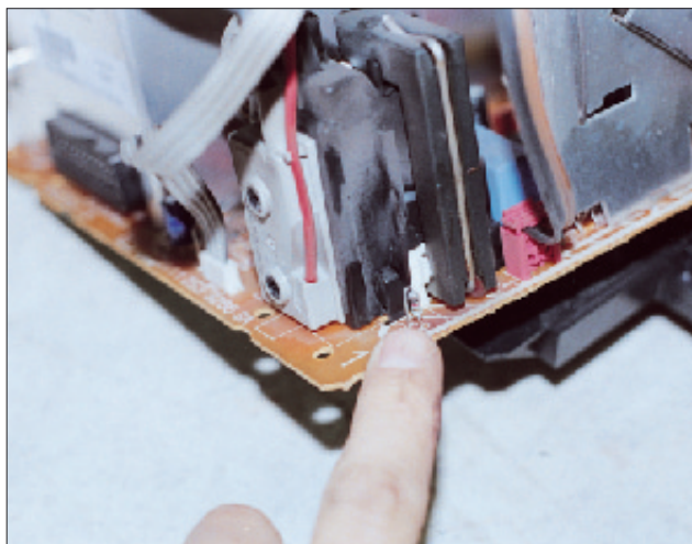
Foto 14 - Posizione del resistore 3430: controllare sempre le saldature del componente indicato e il suo esatto valore Ohmico
