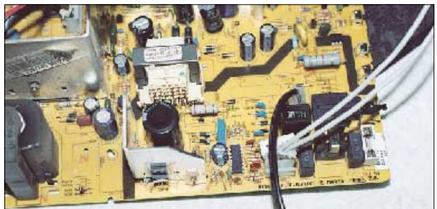
Foto 2 - Stadio d'alimentazione: il cuore del circuito è l'integrato MC44604P visibile a sinistra del cavo d'alimentazione. Si notino i diodi D801/02/03/04 a sinistra del PTC, relativi al ponte di Graetz, mentre in angolo a destra è inserito il fusibile F001
