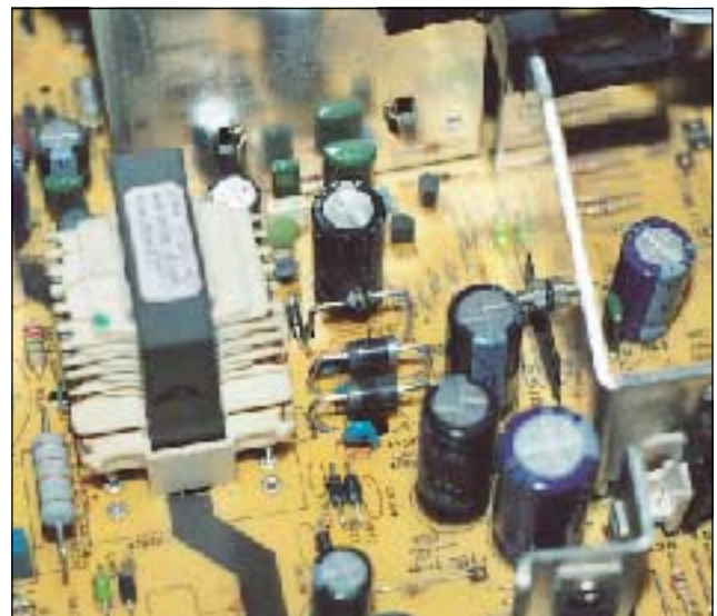
Foto 7 - Stadio secondario d'uscita relativo alla sezione power supply; si noti il diodo D816 rettificatore del +150 V posto vicino ai diodi D815 e D816
