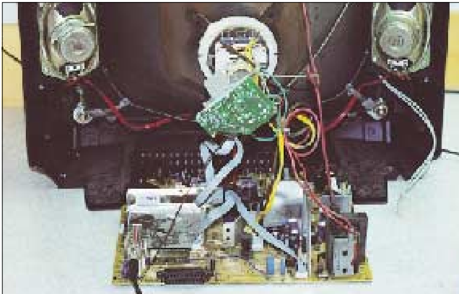
Foto 1 - Ecco come si presenta il Tvc CTV 2003XT una volta tolto lo schienale
