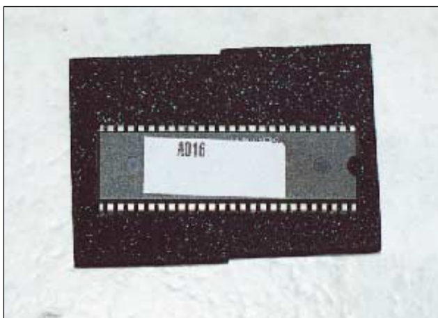
Foto 10 - Il nuovo integrato SDA a 52 pin prima del montaggio sullo zoccolo saldato sullo chassis
