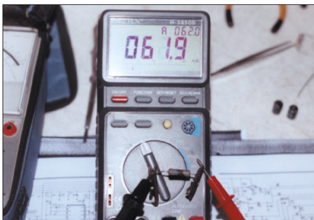
Foto 8 - Il nuovo resistore R419 da 5,6Ω ha avuto una vita "Molto" breve; ecco il suo nuovo valore dopo pochissimi istanti di funzionamento
