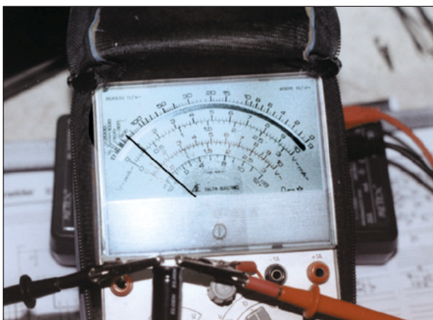
Foto 4 - Isolamento non corretto di C637: si leggono circa 200 kΩ nella prima scala graduata in alto, la portata impiegata nell'Ohmmetro è X1000
