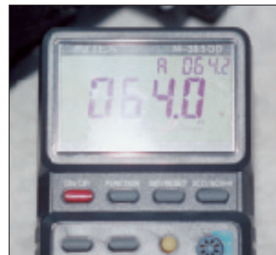
Foto 15 - Durante la fase di Stand-By tutto è nella norma sul catodo di D611
