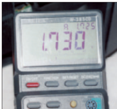
Foto 16 - Anche sul contatto 8 del connettore CN0504 la lettura è perfetta
