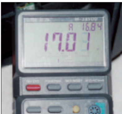
Foto 13 - Trasferitici sulla sezione Power Supply cerchiamo ulteriori conferme sul corretto funzionamento del nostro telaio. La lettura è sull'emettitore di Q612
