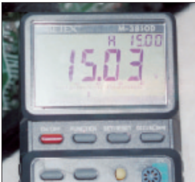
Foto 10 - Dopo la sostituzione del condensatore sulla linea Flyback e la sostituzione del TDA i nostri sforzi danno i primi frutti. La tensione è addotta al pin 2 dell'integrato colpevole del difetto
