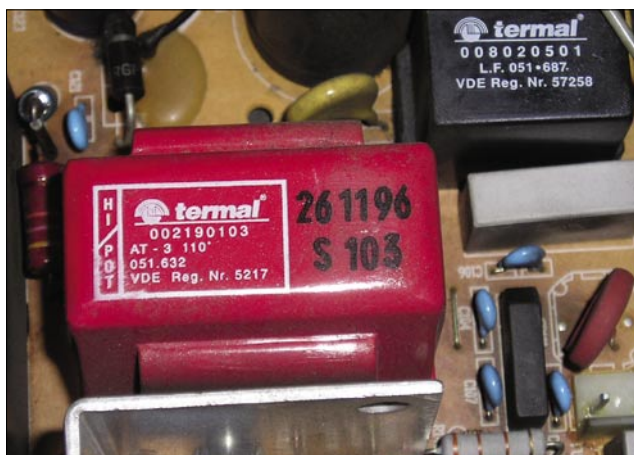
Foto 2 - Il trasformatore switching è molto compatto e posto a ridosso del ponte di diodi
