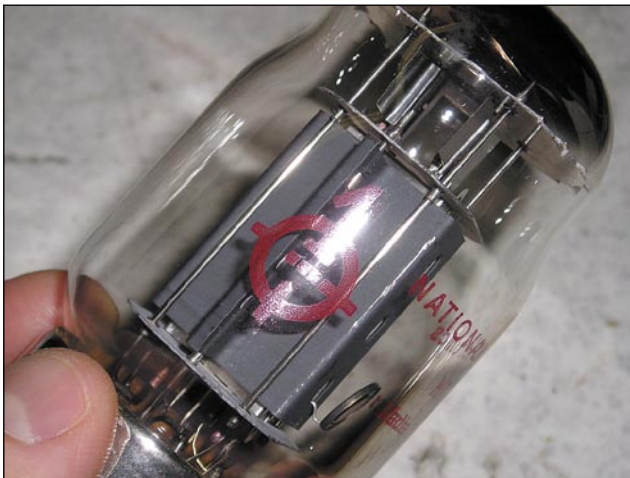
Foto 7 - Ecco una delle nuove KT88 sostituite durante l'intervento
