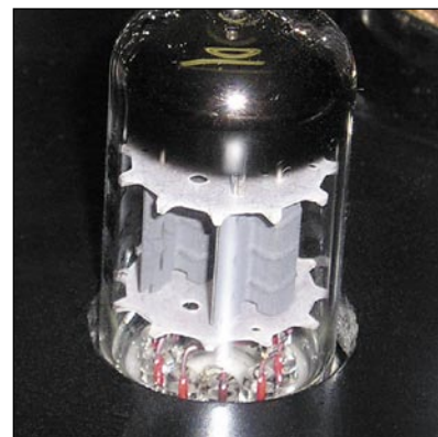
Foto 2 - La ECC82 posta come pilota è situata davanti ai finali di potenza
