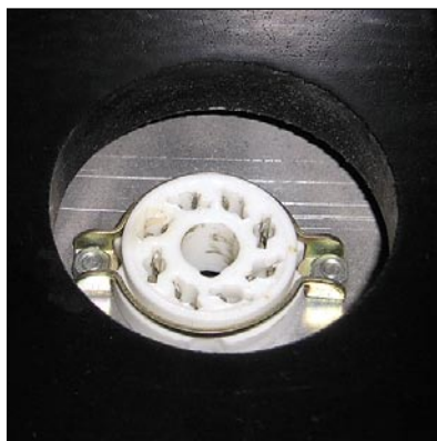
Foto 1 - Ecco come appare uno degli zoccoli delle quattro KT88 impiegate in questo finale audio
