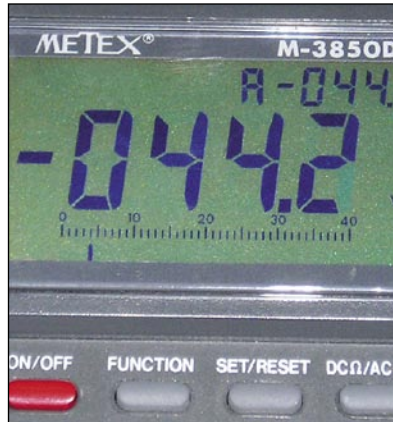
Foto 13 - Tensione di polarizzazione di griglia sul canale destro (catodo)
