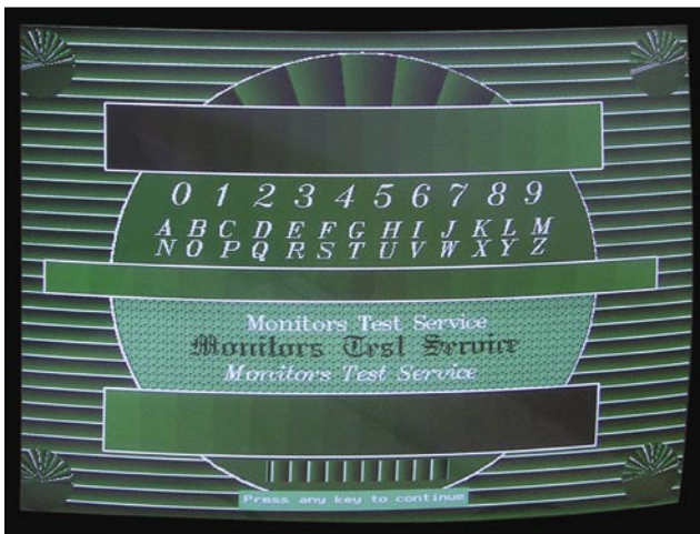
Foto 40 - Scala delle gradazioni in verde. Il cannone Green è il primo a deteriorarsi nel tempo
