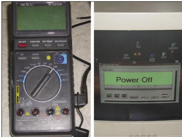
Foto 35 - Il nostro Metex e il suo programma di comunicazione software
