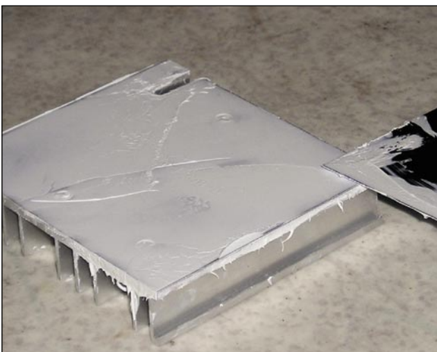
Foto 33 - Ecco il risultato finale dopo il trattamento al silicone
