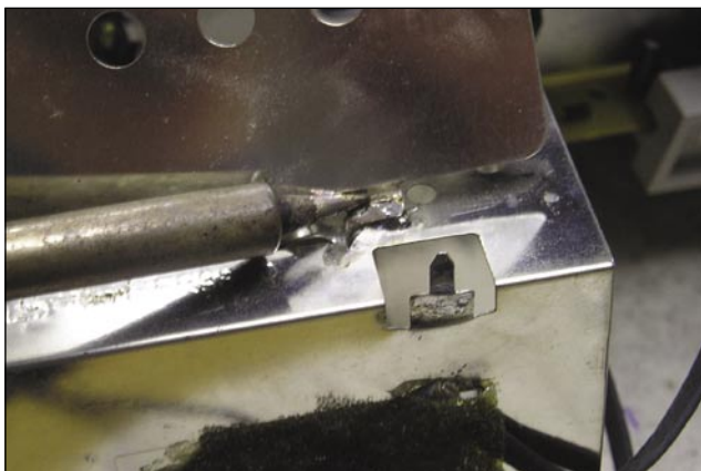
Foto 19 - Sopra lo schermo metallico è presente un'ulteriore protezione metallica che copre il controllo delle bobine atte al controllo statico della convergenza
