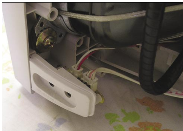
Foto 7 - Attenzione al controllo audio OUT e 15 V! I dentini plastici possono danneggiarsi facilmente all'apertura del Bottom Cover
