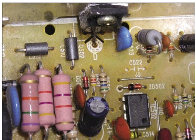
Foto 11 - Il KA3842 di Hitachi e il MOS di IRF sono i principali componenti del Chopper Flyback (sezione SMPS)
