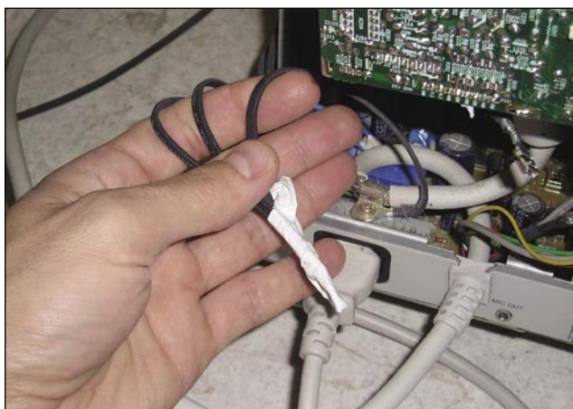
Foto 8 - Isolare come in foto i cavi massa che collegano lo schermo RGB con la calza del TRC. Per smontare ed estrarre lo chassis è indispensabile dissaldarli quasi tutti
