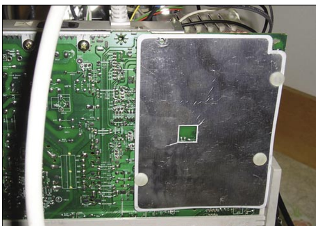
Foto 2 - Posizione dello schermo elettrico a protezione della sezione AHT
