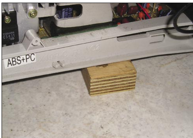
Foto 10 - Per evitare la rottura delle staffe plastiche, utilizzare dei cunei in legno alti 2 cm circa. In questo modo lo chassis non si piega quando il TRC scarica su di esso tutto il suo peso
