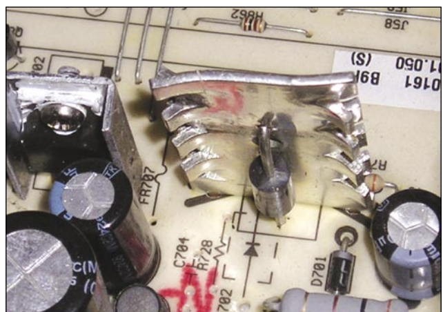
Foto 6 - Diodo D702 responsabile della tensione principale. La sua aletta è indipendente dal contatto di massa
