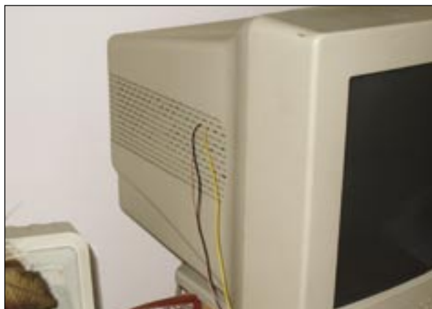
Foto 17 - Cavi di connessione per il nostro tester; il cavo giallo è connesso all'uscita dell'Op-Amp IC1/B
