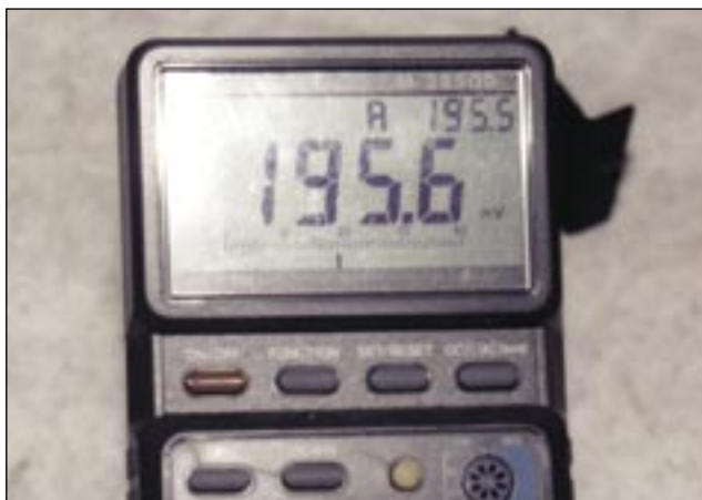
Foto 20 - All'avvio tutto è a temperatura ambiente; abbiamo una tensione differenziale corrispondente a 20° C circa (precisamente 19,5° C)
