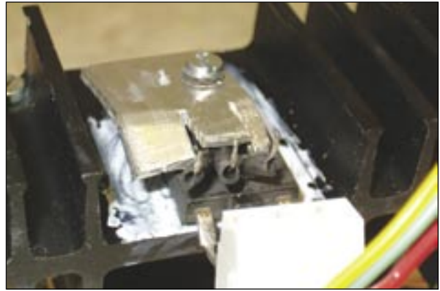
Foto 12 - Praticare un foro circolare con una punta da trapano da 2,5 mm ÷ 3 mm; successivamente sagomare l'alluminio in questo modo
