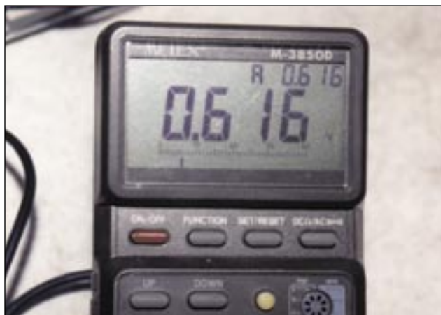
Foto 21 - La tensione di uscita V_o comunica una temperatura del BJT di riga pari a 31° C circa
