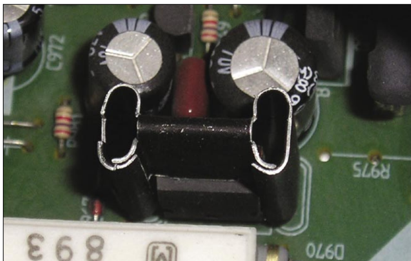
Foto 3 - L'IC952 e la sua piccola aletta di raffreddamento sono situati nei pressi della sezione secondaria dell'SMPS
