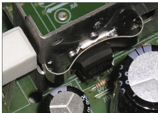
Foto 6 - Il transistor Q957 è dedito al controllo della +8 V
