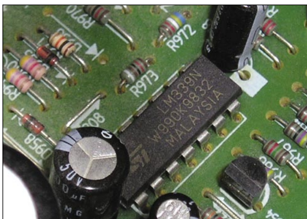
Foto 5 - Il quadruplo Op-Amp LM339 è situato a valle del trasformatore switching
