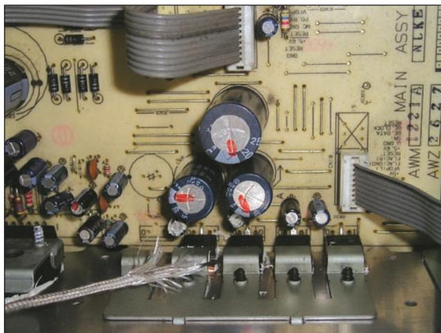
Foto 15 - Controllo termico sugli stabilizzatori integrati
