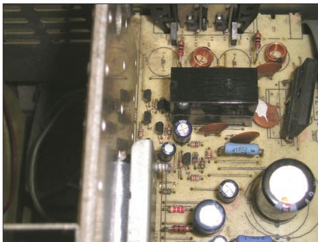
Foto 19 - Relè utilizzato come anti Bump (modello Omron a 24 V)
