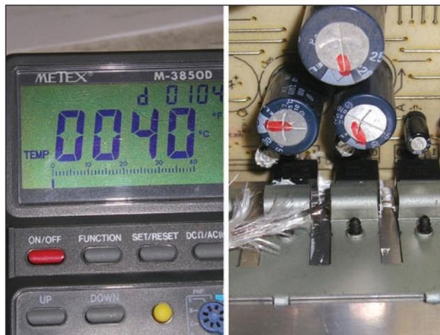
Foto 16 - Contatto della termocoppia e lettura diretta su display
