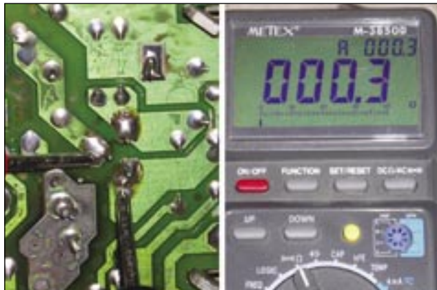
Foto 8 - Primo controllo a verifica dei nostri ragionamenti: la B-C è in forte cortocircuito
