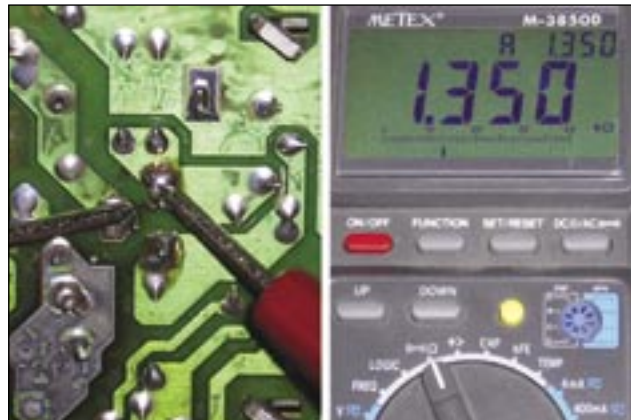
Foto 9 - La giunzione B-E sembrerebbe funzionante, ma ormai il BJT è da sostituire
