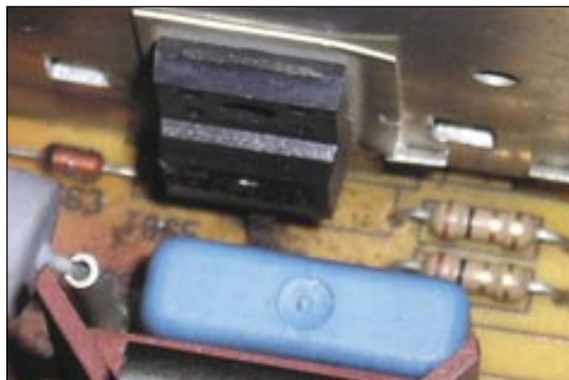
Foto 4 - A destra del T665 è possibile vedere i due resistori sense current posti in parallelo
