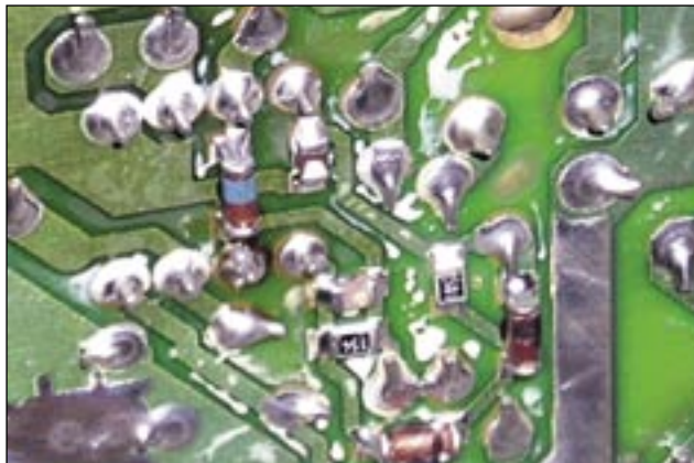
Foto 2 - Ecco alcuni componenti SMD dedicati al controllo del duty-cycle
