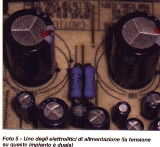
Foto 5 - Uno degli elettrolitici di alimentazione (la tensione su questo impiego è duale)
