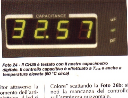
Foto 24 - Il CH36 è testato con il nostro capacimetro digitale. Il controllo capacitivo è effettuato a T amb e anche a temperatura elevata (60 °C circa)
