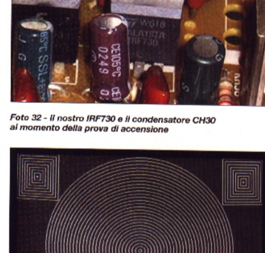
Foto 32 - Il nostro IRF730 e il condensatore CH30 al momento della prova di accensione
