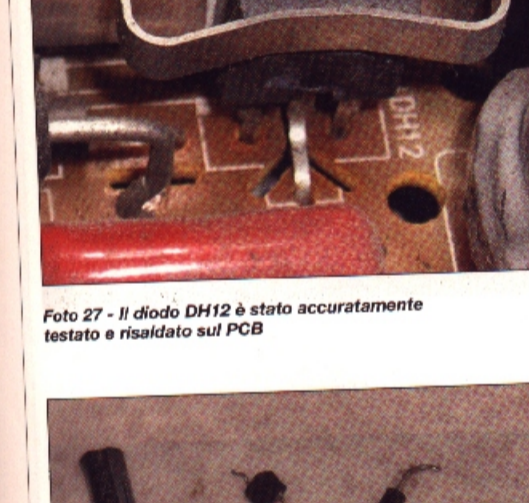
Foto 27 - Il diodo DH12 è stato accuratamente testato e risaldato sul PCB
