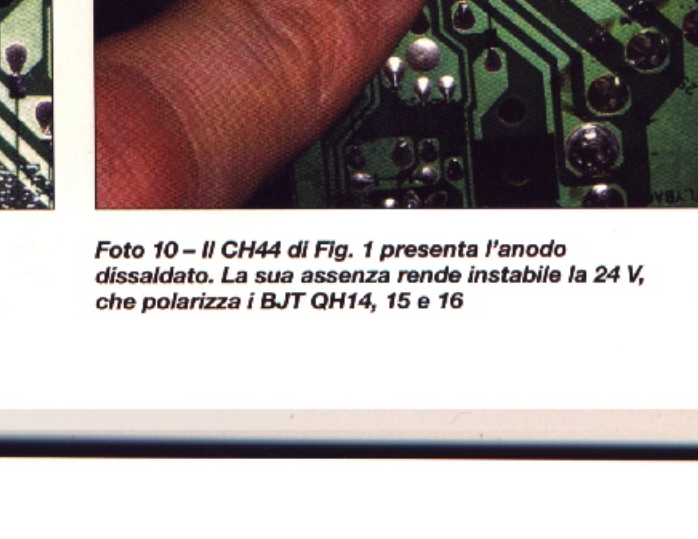
Foto 10 - Il CH44 di Fig. 1 presenta l'anodo dissaldato. La sua assenza rende instabile la 24 V, che polarizza i BJT QH14, 15 e 16
