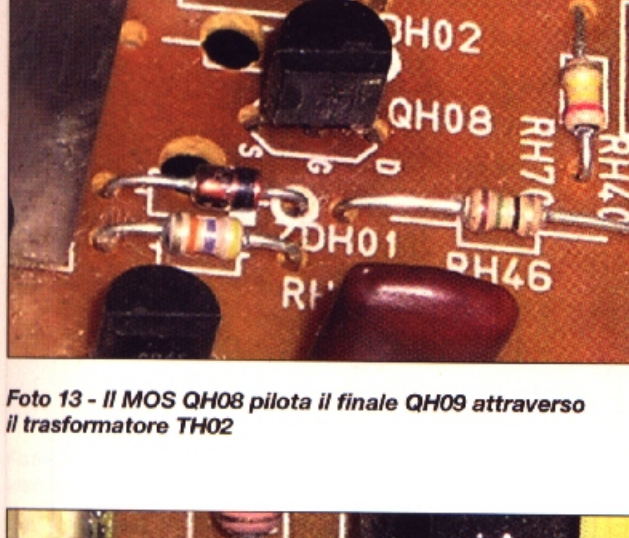
Foto 13 - Il MOS QH08 pilota il finale QH09 attraverso il trasformatore TH02
