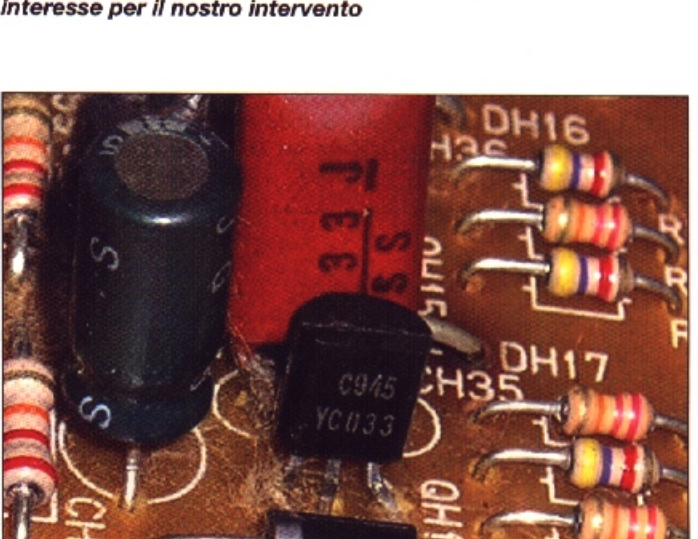
Foto 19 - Il contatto CS2 è il pin di principale interesse per il nostro intervento
