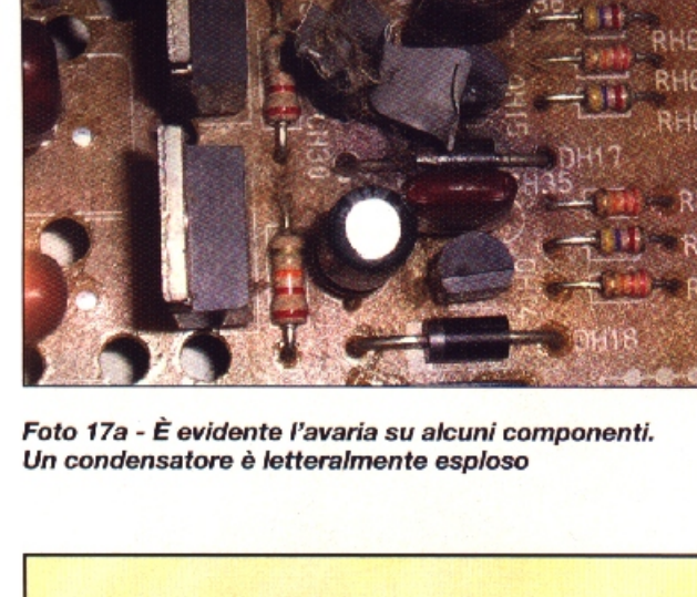
Foto 17a - È evidente l'avaria su alcuni componenti. Un condensatore è letteralmente esplosivo
