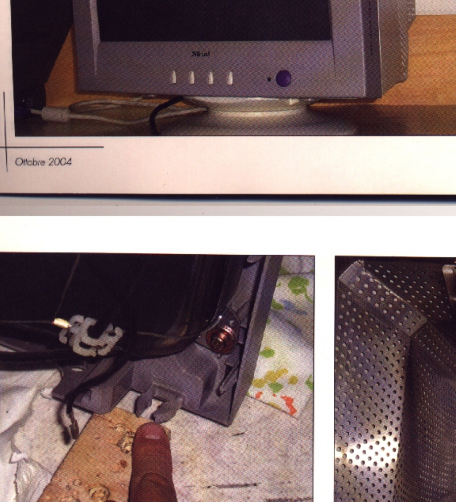
Foto 1 - Per togliere il coperchio posteriore bisogna agire sui blocchi plastici indicati in foto
