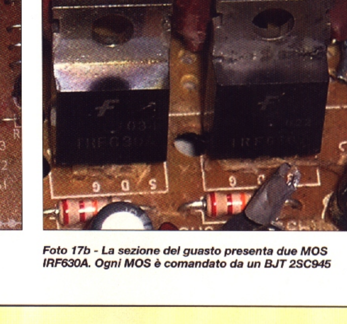
Foto 17b - La sezione del guasto presenta due MOS IRF630A. Ogni MOS è comandato da un BJT 25C945
