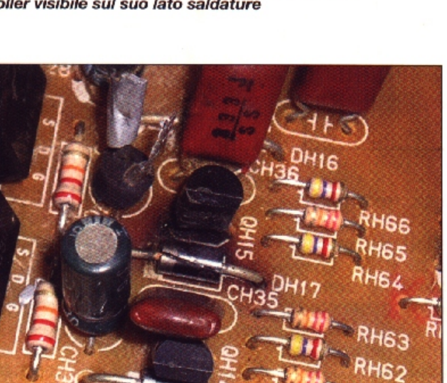
Foto 18 - I comandi ai BJT pilota sono effettuati dal controller visibile sul suo lato saldature
