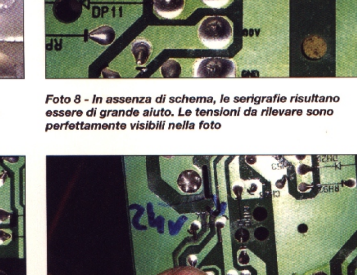
Foto 8 - In assenza di schema, le serigrafie risultano essere di grande aiuto. Le tensioni da rilevare sono perfettamente visibili nella foto
