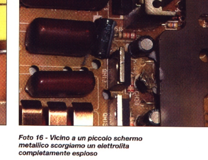
Foto 16 - Vicino a un piccolo schermo metallico scorgiamo un elettrolita completamente esplosivo
