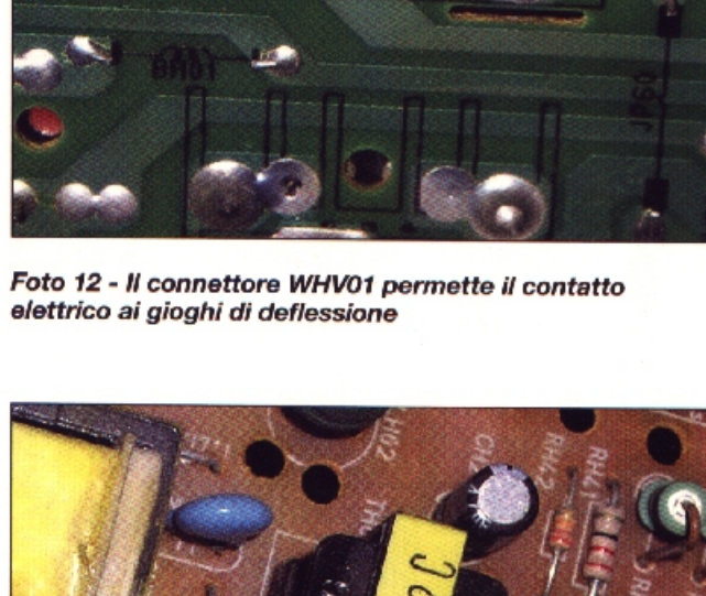
Foto 12 - Il connettore WHV01 permette il contatto elettrico ai giochi di deflessione
