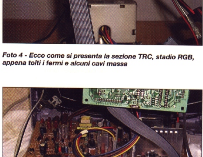
Foto 4 - Ecco come si presenta la sezione TRC, stadio RGB, appena tolti i fermi e alcuni cavi massa
