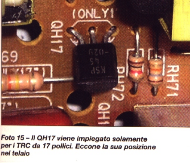
Foto 15 - Il QH17 viene impiegato solamente per il TRC da 17 pollici. Eccone la sua posizione nel telaio
