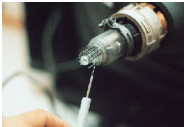
Foto 9 - Sono visibili le forti incrostazioni sui contatti del TRC ... il trasformatore non avrebbe potuto avere una vita molto lunga
