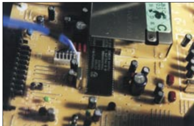
Foto 14 - Al centro è visibile il controllore impiegato in questo telaio; leggermente in basso a destra è visibile Q1101 dedicato al controllo C-A-T-S
