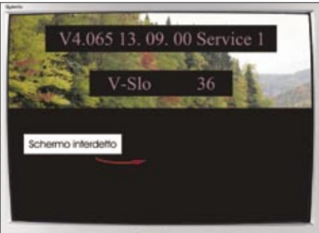
Foto 11 - Controllo service rampa verticale, valore da noi impostato: 36
