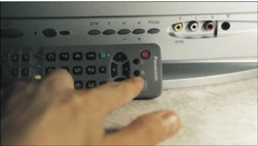
Foto 8 - Nella foto sono visibili il tasto sul TLC utilizzato per il Service Mode e il tasto "V" sulla Key-board
