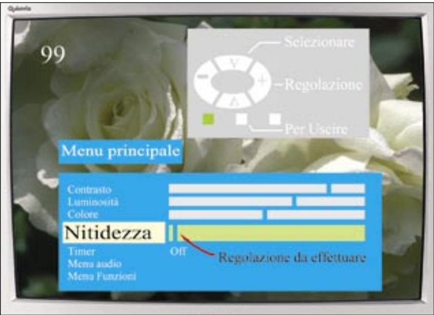
Foto 7 - Per operare sul Service Mode visualizzare il programma 99 (in alto a sinistra sul TRC). È altresì indispensabile settare al minimo il controllo della Nitidezza, come mostrato in foto
