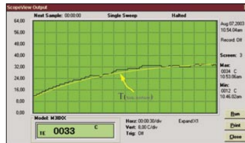
Fig. 9 - La temperatura Aletta-Ambiente relativa al transistore di deflessione orizzontale è corretta. Ecco l'andamento da rilevare per i primi tre minuti dopo l'accensione del TVC
