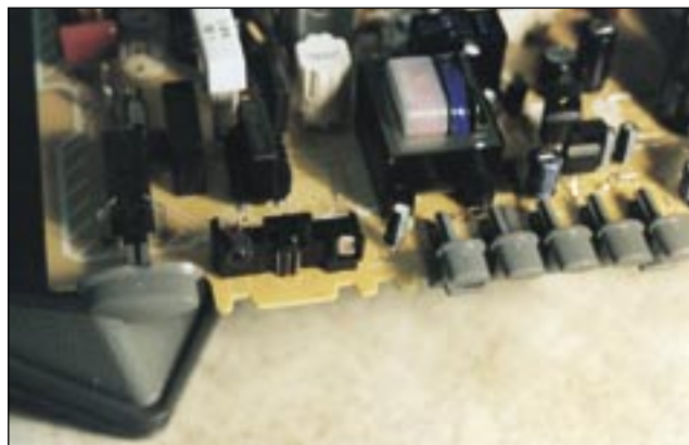
Foto 13 - Il foto-resistore è posto sul pannello frontale accanto al led di pre-accensione e al ricevitore IR
