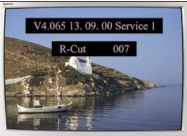
Foto 12 - Controllo service spegnimento del Rosso, valore da noi impostato: 007
