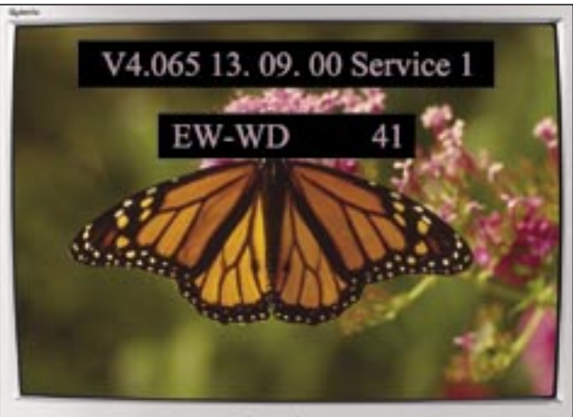
Foto 10 - Controllo service E/W, valore da noi impostato: 41
