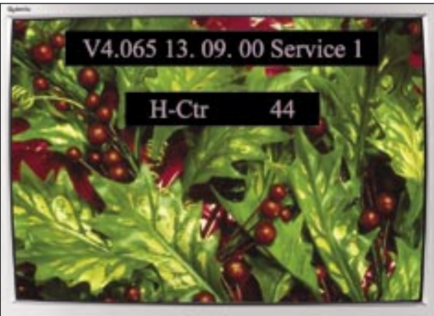
Foto 9 - Controllo service centratura orizzontale, valore da noi impostato: 44
