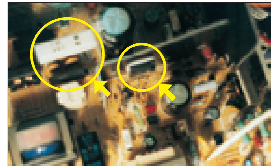
Foto 1A - Al centro della foto abbiamo IC801, mentre a sinistra si nota il PTC della smagnetizzazione; poco sopra si noti il ponte di diodi oggetto della sostituzione
