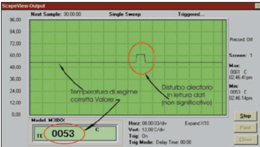
Fig. 6 - Il disturbo visibile nella figura è dato dallo spostamento della termocoppia durante i controlli
